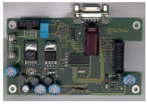
Kontaktiereinheit Pushmatic mit Veriegelungsdetektor
