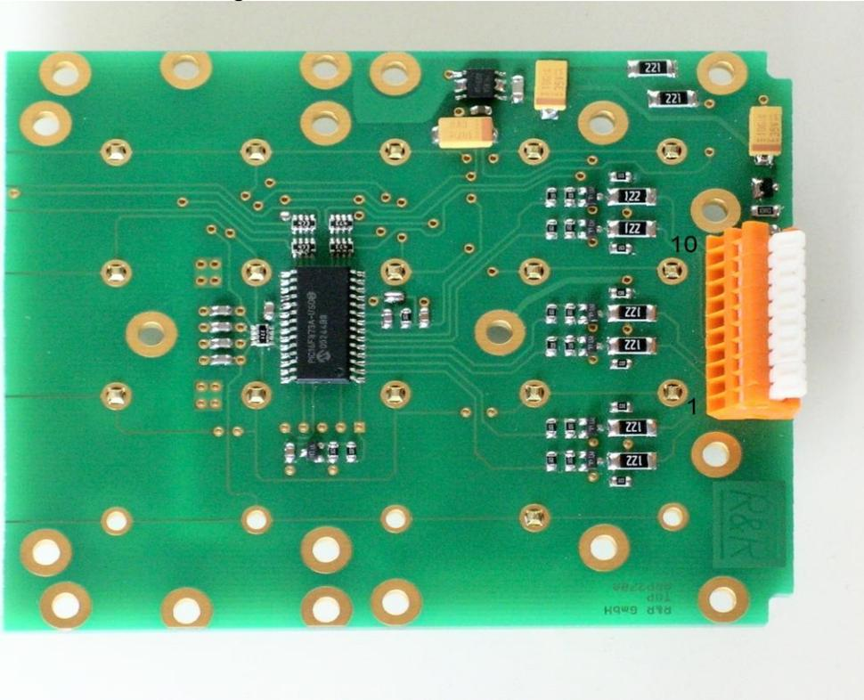
Die 24V Ausgänge sind dauerkurzschlussfest (ca. 20mA im Kurzschlußfall),
